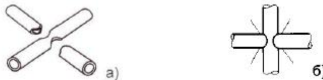
Рис. 4 -Расположение отверстий при конструировании узла Б.
